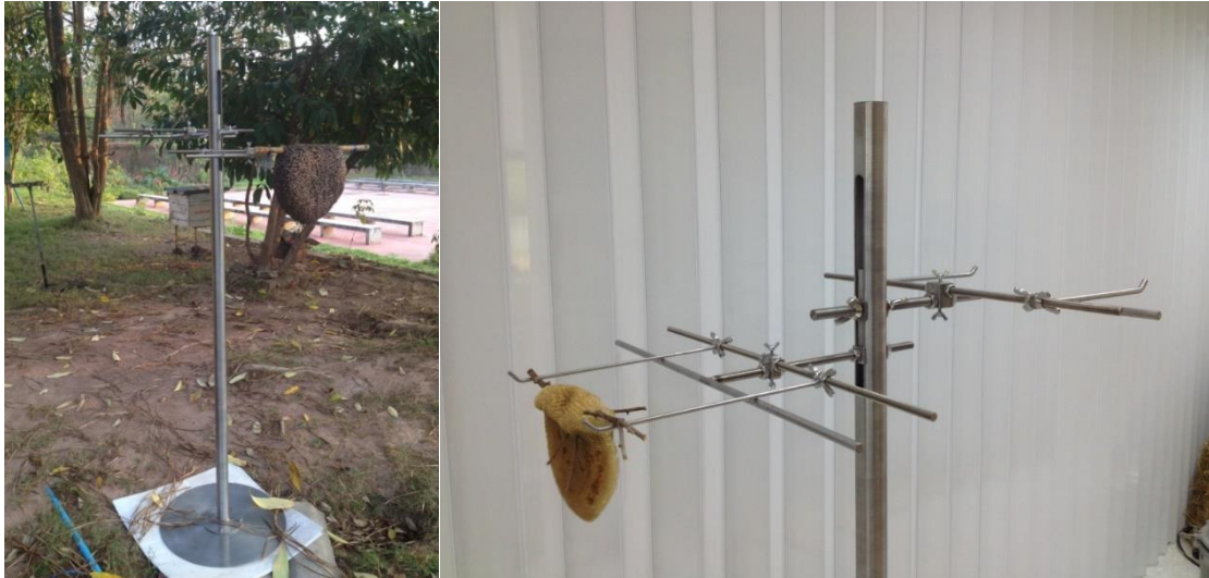
ภาพที่ 3.21 ขาตั้งแขวนรังผึ้งมีมจากวัสดุอุปกรณ์ที่ทำจากแสดนเลท
