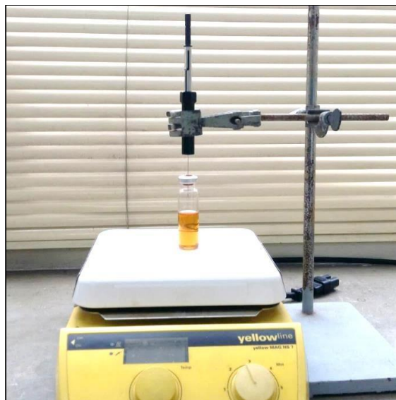
ภาพที่ 2.2 ภาพแสดงการดูดซับเพื่อสกัดสารอินทรีย์ระเหยง่ายจากตัวอย่างน้ำผึ้ง
