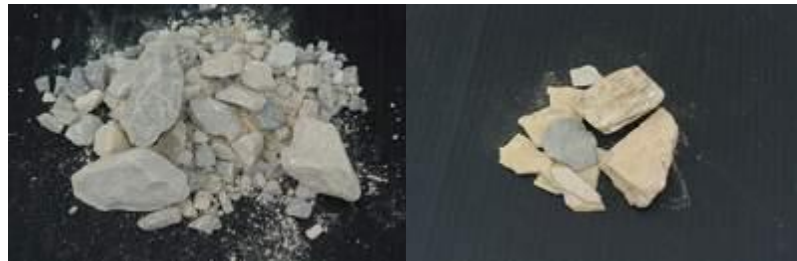
ภาพที่ 2.1 ตัวอย่างวัตถุดิบที่ใช้ในกระบวนการผลิต; ก.หินปูน (Lime Stone) ข.หินดินดาน (Shale)
