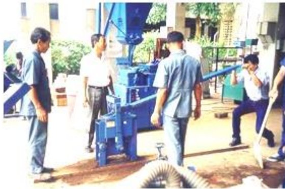
ภาพที่ 2.8 ขั้นตอนการนำดินที่ผสมแล้วเข้าเครื่องอัด (วุฒินัย กกกำแหง และพิชิต เจนบรรจง, ม.ป.ป.)
