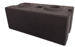
รูปบล็อกประสานที่มีการแทนที่ดินลูกรังด้วยเถ้าขานอ้อยในปริมาณ 10 โดยน้ำหนัก
