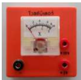
รูปที่ 1 โวลต์มิเตอร์และการต่อโวลต์มิเตอร์ในวงจร
