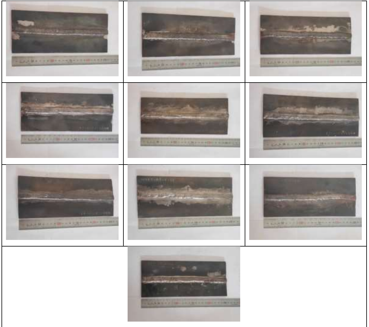
รูปที่ 4.8 ชิ้นงานฝึกภาคปฏิบัติสำหรับการทดสอบโดยวิธีสารแทรกซึม
