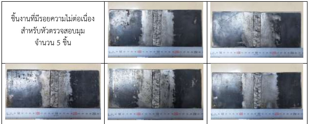
รูปที่ 4.11 ชิ้นงานสำหรับการทดสอบโดยวิธีคลื่นเสียงความถี่สูง ซึ่งเป็นชิ้นงานเชื่อมที่มีรอยความไม่ต่อเนื่องสำหรับหัวตรวจสอบมุม
