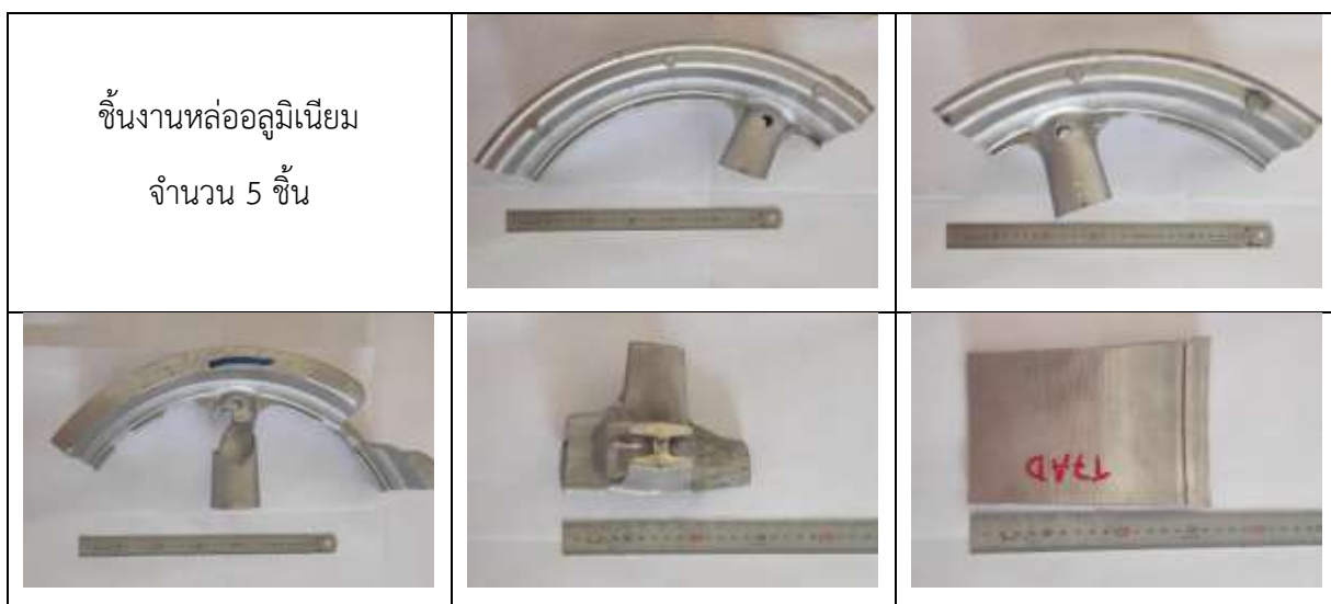
รูปที่ 4.6 ชิ้นงานสำหรับการทดสอบโดยวิธีตรวจพินิจ ซึ่งเป็นชิ้นงานหล่ออลูมิเนียม
