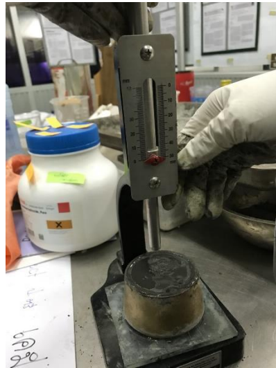
รูปที่ ก. 1 การหาปริมาณน้ำที่เหมาะสมของจีโอโพลีเมอร์เพสต์ด้วยวิธีไวแคต
