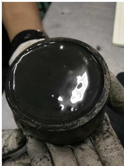
รูปที่ ก. 2 จีโอโพลีเมอร์เพสต์ที่ผ่านการปาดผิวเพื่อเตรียมสำหรับทดสอบไวแคต
