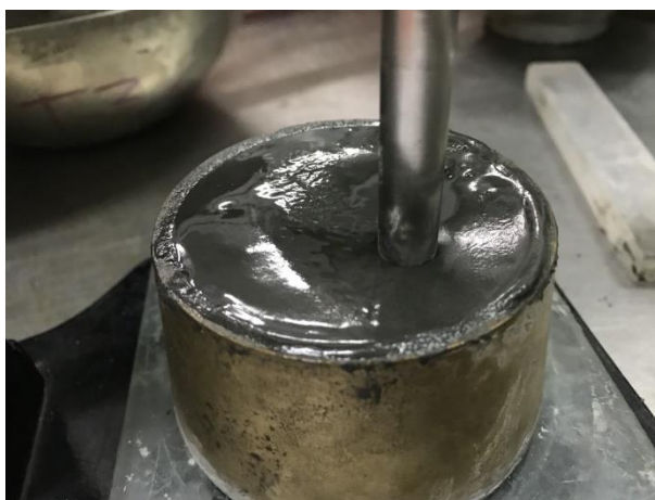
รูปที่ ก. 3 การเลื่อนเข็มไวแคตมาสัมผัสกับผิวหน้าของจีโอโพลีเมอร์เพสต์
