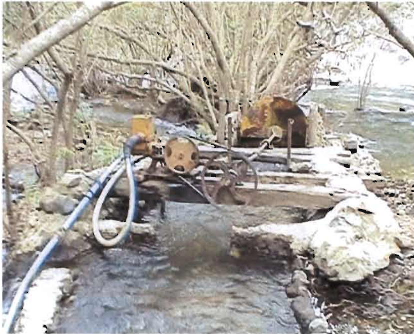
ระบบแรงน้ำผลักดันกังหันหมุน น้ำจากลำธารขึ้นมาใช้ในรีสอร์ท
