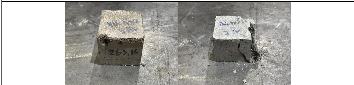
รูปที่ 7 ชิ้นงานทดสอบหลังการทดสอบกำลังรับแรงอัด
