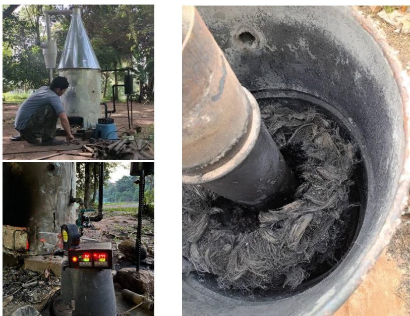
รูปที่ 4 ลักษณะเตาเผาและถ่านเชื้อเพลิงชีวภาพที่ได้
