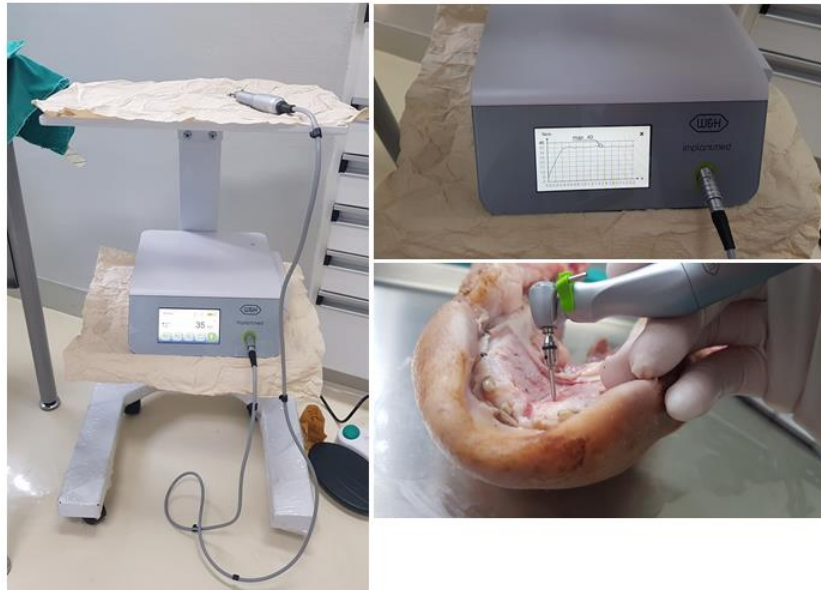
รูปที่ 3.3 แสดงเครื่อง Implantmed Surgical Unit รุ่น SI-1023 ที่ใช้วัดแรงบิด และ ลักษณะการวางหัวกรอให้ตั้งฉากกับกระดูกขากรรไกรขณะทำการฝัง
