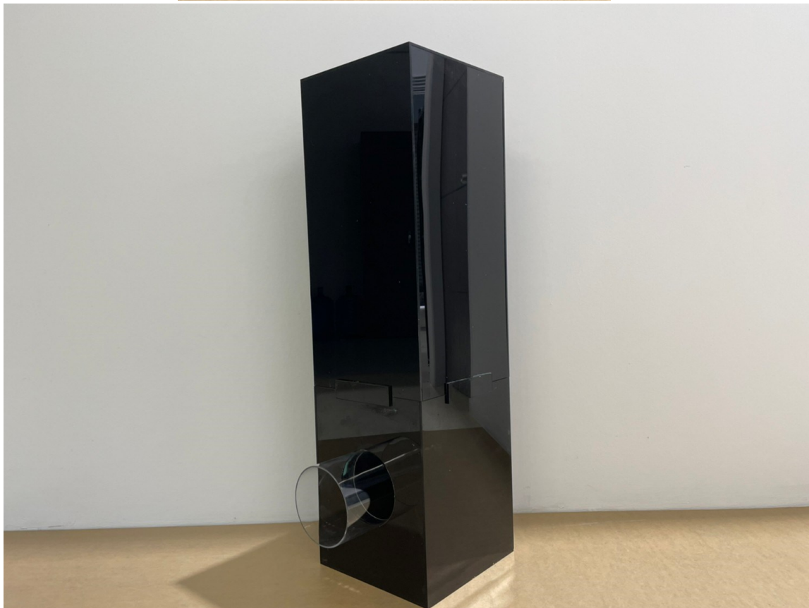
รูปที่ 24 โครงสร้างภายนอกของหน่วยบำบัดที่ใช้ตัวกลางแบบเคลื่อนที่
