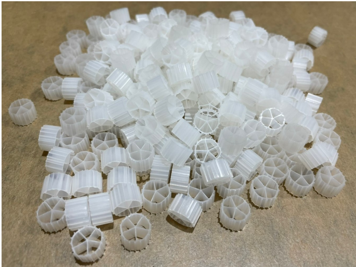
รูปที่ 11 ตัวกลางแบบเคลื่อนที่ที่ผ่านการเคลือบไทเทเนียมในปริมาณร้อยละ 15 โดยน้ำหนัก
