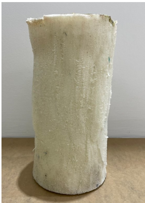
รูปที่ 8 ตัวกรองอากาศเซรามิกจากวัสดุพูนจากจีโอพอลิเมอร์ผสมเถ้าชีวมวลและแคลเซียมคาร์บอเนต
