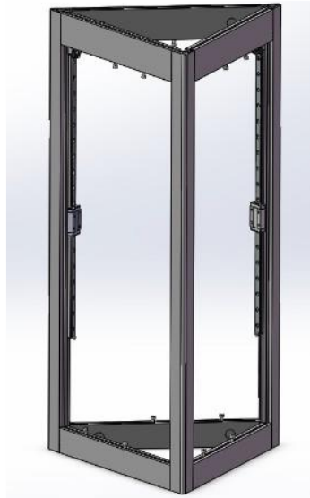
รูปที่ 4.1 โครงสร้างเครื่องพิมพ์ 3 มิติ ชนิด Delta
