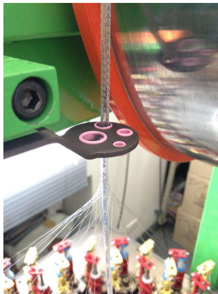
รูปที่ 3.3 ภาพแสดงลักษณะการใส่หลอดเข้ากับเครื่องสาน
