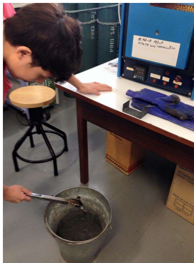
รูปที่ 3.7 ภาพแสดงการทำให้เย็นตัวอย่างรวดเร็ว Quenching
