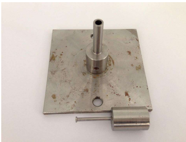
รูปที่ 3.18 อุปกรณ์ชุดทดสอบ Axial Compression
