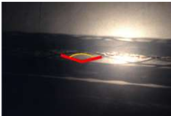
รูปที่ 3.10 ภาพแสดงลักษณะของการวัดมุมโดยเครื่อง Profile Projector
