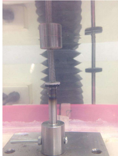
รูปที่ 3.14 ลักษณะการสอดขดลวดค้ำยันหลอดเลือดหัวใจกับชุดทดสอบ
