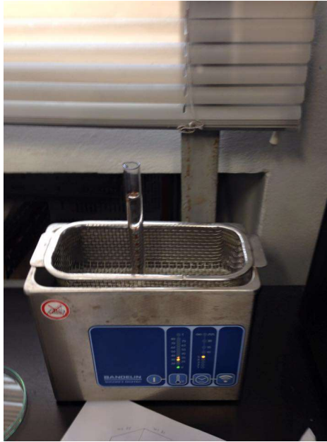
รูปที่ 3.9 ภาพแสดงการสั่นเพื่อกำจัดอนุภาคต่างๆด้วยเครื่อง ultrasonic cleaning
