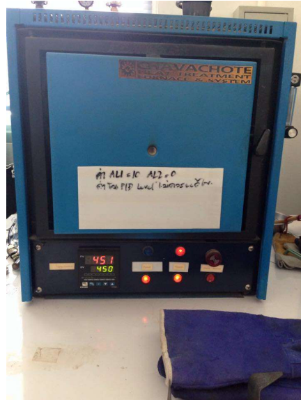
รูปที่ 3.6 ภาพแสดงการอบด้วยเตา Heat treatment furnace
