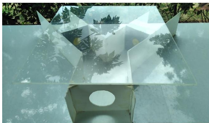
รูปที่ 3.2 Y - maze ที่ได้สร้างขึ้นเพื่อทำการทดลอง (บน) ไม่มีแผ่นอะคริลิกปิดด้านบน (ล่าง) มีแผ่นอะคริลิกปิดด้านบนเมื่อทำการทดลองเพื่อไม่ให้ผึ้งบินออกจาก Y-maze
