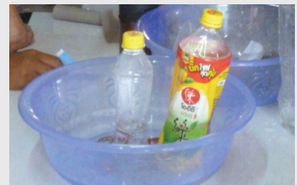
รูปแสดงการทดลองวางขวดที่บรรจุน้ำร้อนและน้ำเย็นลงในกะละมังน้ำเย็น เพื่อดูการบีบตัวของขวด
