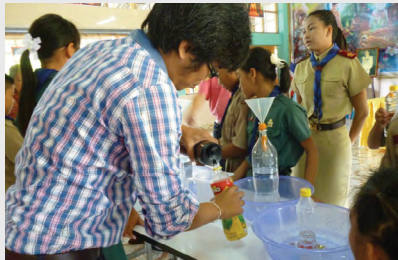
รูปแสดงวิทยากรกำลังเทน้ำร้อนใส่ขวดหลังจากที่ได้เทน้ำอุณหภูมิห้องลงในขวดแรกไปแล้ว และทำการวางขวดทั้ง 2 ลงในกะละมังที่เต็มไปด้วยน้ำเย็น
