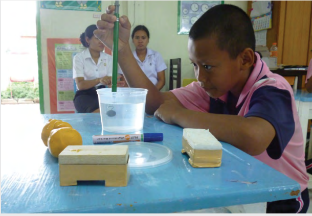
รูปแสดงนักเรียนกำลังชั่งลูกตุ้มในน้ำด้วยเครื่องชั่งสปริงและอ่านค่าที่ได้
