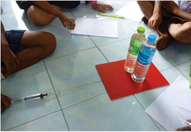
รูปแสดงนักเรียนกำลังชั่งน้ำหนักของน้ำดื่ม จำนวน 2 ขวด ด้วยเครื่องชั่งสปริง บนผิวสัมผัสที่ทำจากพีวีเอเจอร์บอร์ด
