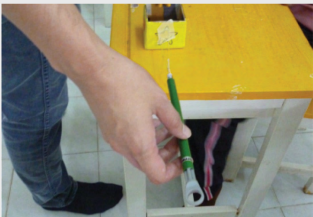
รูปแสดงวิทยากรกำลังชี้เครื่องชั่งสปริงลากกล่องกระดาษที่บรรจุลูกตุ้มและดินน้ำมันที่วางบนพื้นโต๊ะเรียบ เพื่ออ่านค่าน้ำหนักที่ได้
