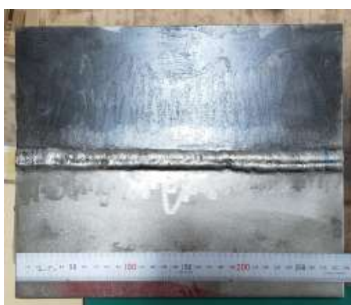
รูปที่ 3.10 ชิ้นงานเชื่อมโลหะต่างชนิดระหว่างเหล็กกล้าไร้สนิมและเหล็กกล้าคาร์บอน
