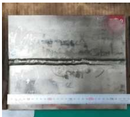
รูปที่ 3.8 ชิ้นงานเชื่อมเหล็กกล้าไร้สนิม
