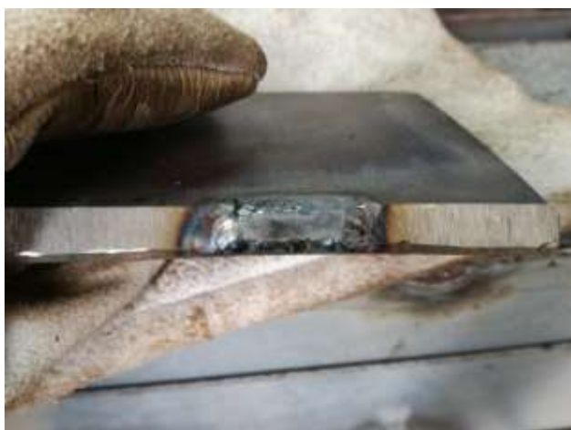
รูปที่ 3.11 การจำลองรอยความไม่ต่อเนื่องชนิดหลอมละลายด้านข้างไม่สมบูรณ์
