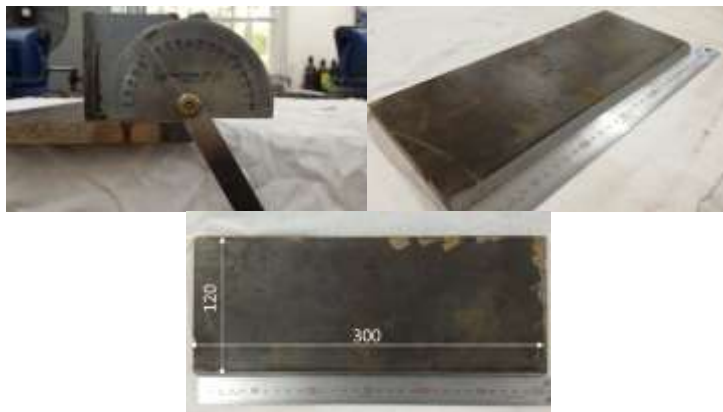
รูปที่ 3.6 ขนาดชิ้นงานเหล็กกล้าคาร์บอนสำหรับสร้างชิ้นงานเชื่อมที่มีรอยความไม่ต่อเนื่องภายใน
