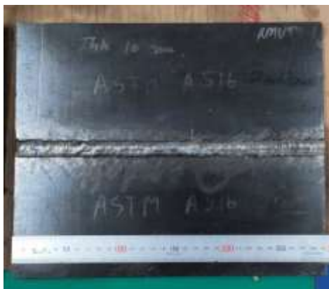
รูปที่ 3.9 ชิ้นงานเชื่อมเหล็กกล้าคาร์บอน
