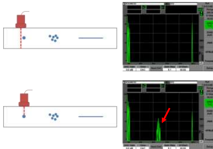
รูปที่ 2.1 การทดสอบโดยวิธีคลื่นเสียงความถี่สูง
