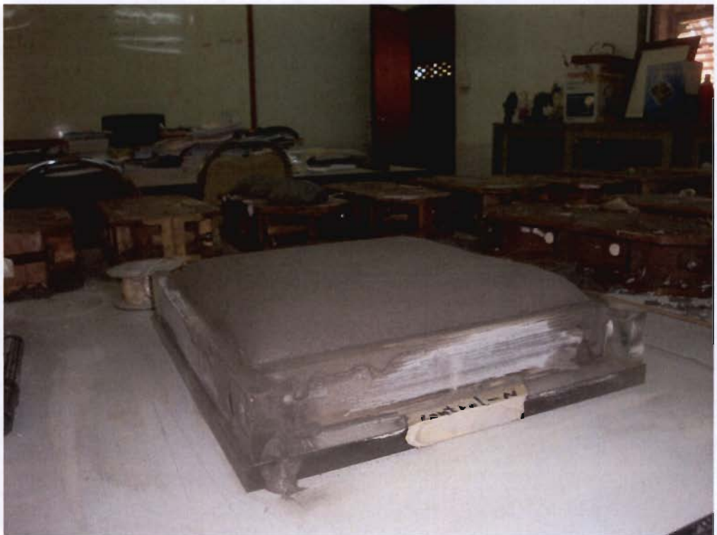
รูปที่ จ.2 ลักษณะการหล่อตัวอย่างคอนกรีตมวลเบาขนาด 20 x 20 x 3 เซนติเมตร
