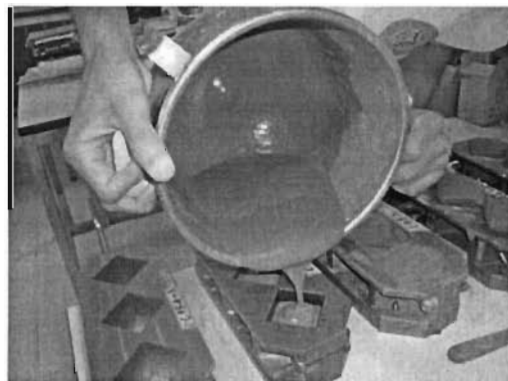
รูปที่ 3.5 การเทเนื้อมอร์ตาร์ประมาณ 2 ใน 3 ของความสูงของแบบหล่อ
