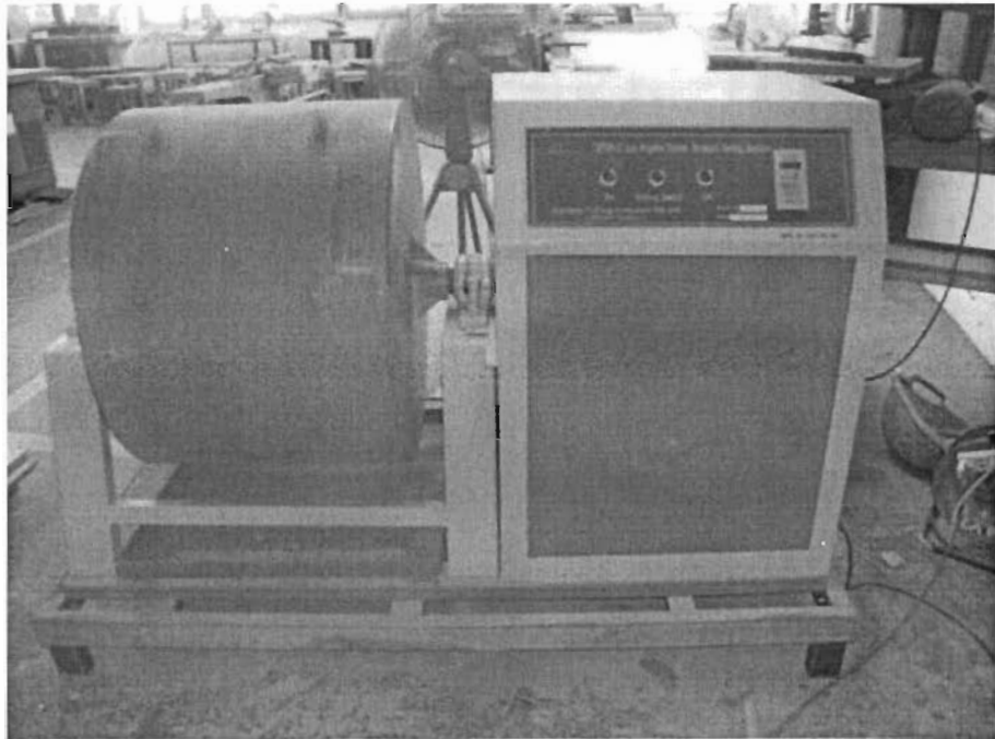
รูปที่ 3.1 Los Angeles Abrasion Machine
