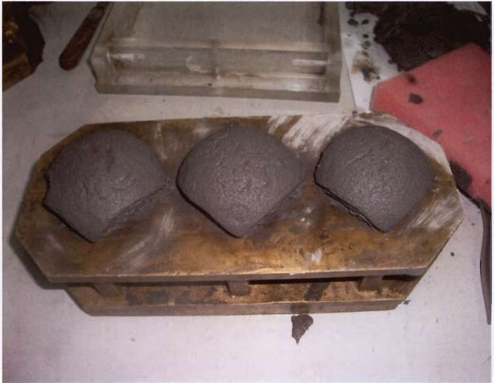
รูปที่ จ.1 ลักษณะการหล่อตัวอย่างคอนกรีตมวลเบาขนาด 5 x 5 x 5 เซนติเมตร
