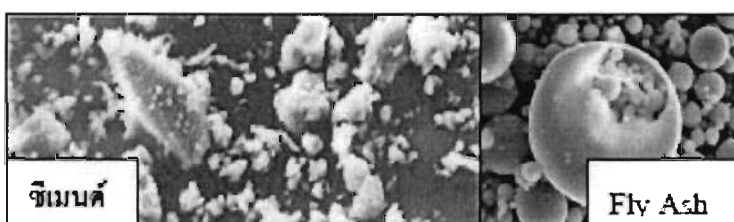
รูปที่ 2.3 อนุภาคของซีเมนต์ เทียบกับอนุภาคของ เถ้าลอยบดละเอียด [11]
