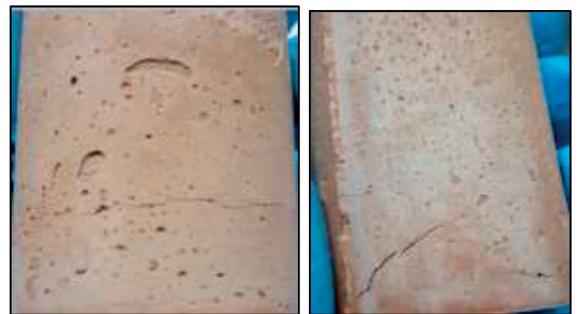
รูปที่ 5 รอยแตกร้าวของก้อนจีโอพอลิเมอร์สังเคราะห์จากบิสกิตที่มีการกระตุ้นปฏิกิริยาด้วยโซเดียมไฮดรอกไซด์ และโพแทสเซียมไฮดรอกไซด์ที่บ่มด้วยอุณหภูมิ 50 และ 70 องศาเซลเซียส
